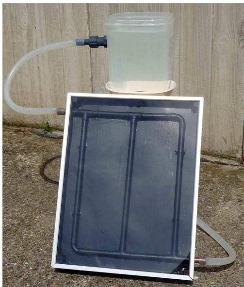
Füllt mit der Gießkanne den Behälter bis zur Markierung mit Wasser. Der Füllstand muss höher sein als der obere Auslauf.
